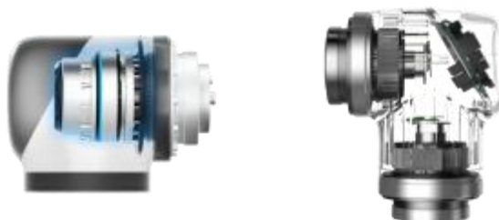
图 4 协作机器人一体化关节
