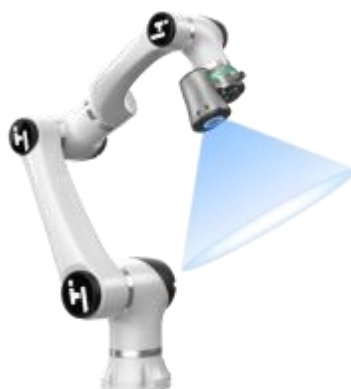
图 6 协作机器人视觉识别方案
